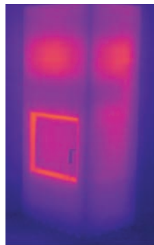
8 Std. nach dem Anheizen Durchschnittliche Oberflächentemperatur 46 °C
